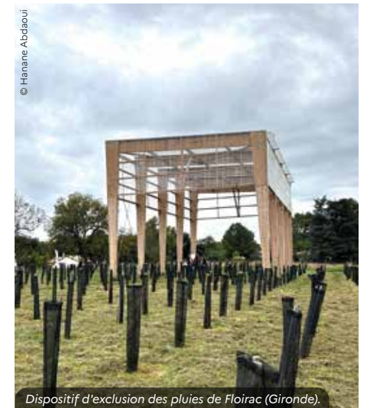
Dispositif d'exclusion des pluies de Floirac (Gironde).
